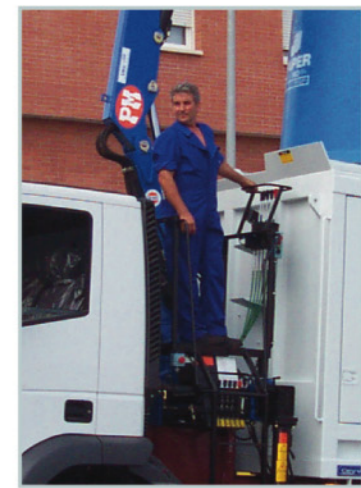
Raised control station: maximum angle of visibility. Puesto de maniobra en pie: máximo ángulo de visibilidad.
