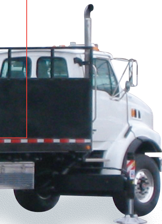
Hydraulic outrigger booms Brazos estabilizadores a salida hidráulica
