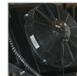
Heat exchanger Cambiador de calor
