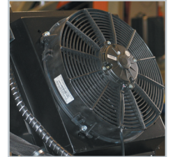
Heat exchanger. Cambiador de calor.
